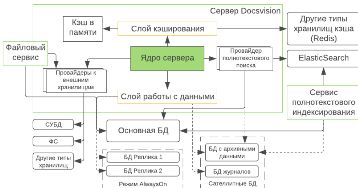
Рисунок 1. Архитектура модуля Платформа
